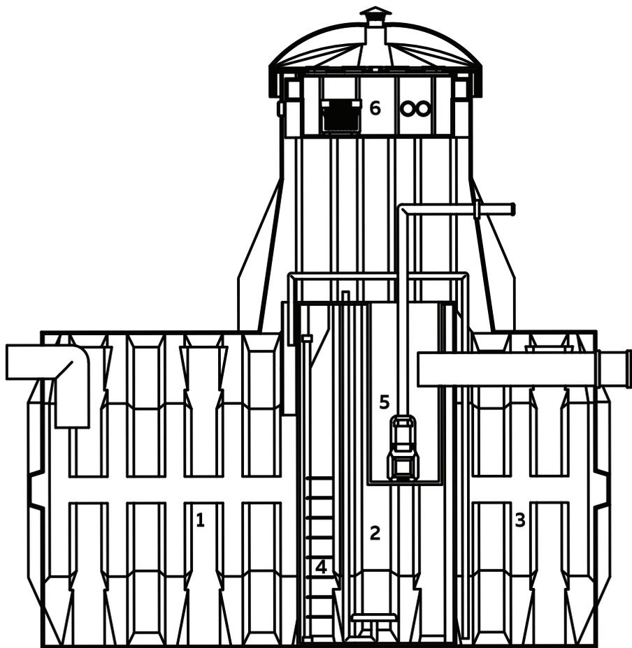
1. Приемная камера, 2. Аэротэнк, 3. Камера гравитационного осаждения активного ила, 4. Волосоуловитель, 5. Блок-успокоитель очищенной воды, 6. Блок управления
